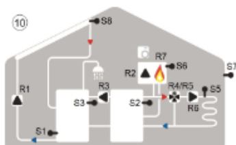
10 Solár, zásobník, akumuláční nádoba a hořák
