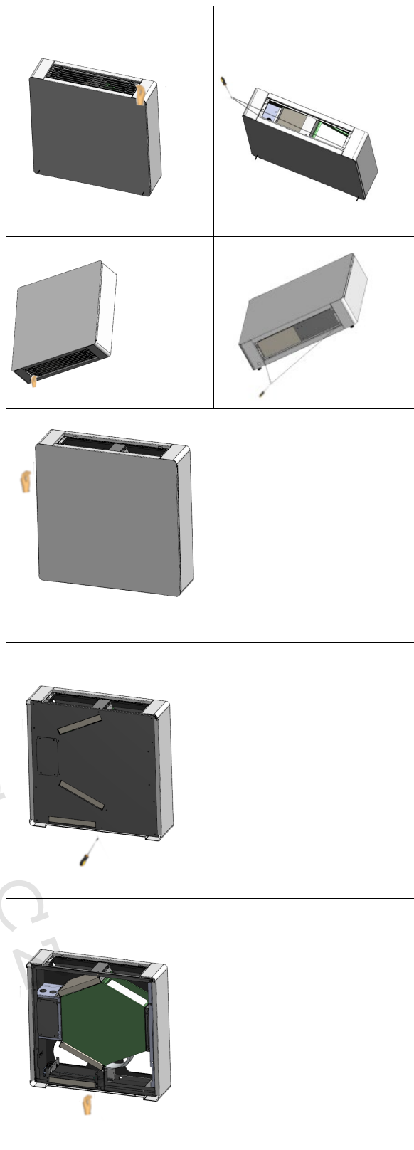
Postup vyjmutí výměníku tepla
