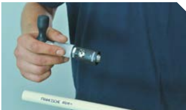
Vložení odhrotovacího nástavce příslušného průměru 16 - 32 mm do univerzálního držáku.
