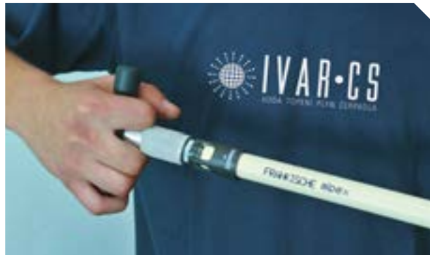
Kalibrace, odhrotování a úprava čela trubky otáčením ve směru hodinových ručiček.
